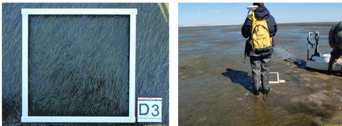
Figure 1 : Détails d'un cadrat de 50 cm de côté montrant la très forte densité en plusieurs couches de feuilles superposées de *Zostera noltei*. L'herbier est en très bon état. Chaque point sur de la grille est repéré au DGPS Trimble et le matériel encombrant est transporté dans un petit « acon ».
