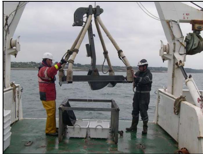
Figure 29 : Mise en œuvre de la benne Hamon
