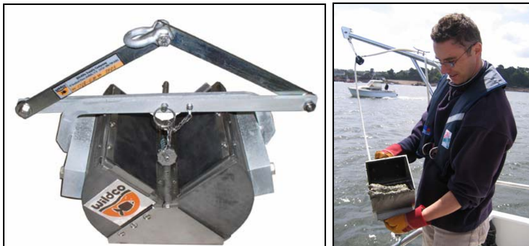
Figure 28 : Benne Petite Ponar et sa mise en œuvre
