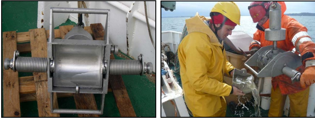
Figure 27 : Benne Shipek et sa mise en oeuvre
