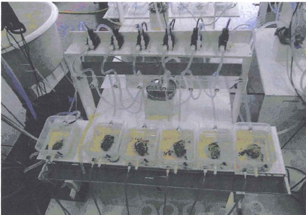
Figure 3 : Stand sur lequel sont disposées les six boîtes individuelles contenant chacune une huître. On distingue derrière le stand la chambre d'homogénéisation.
