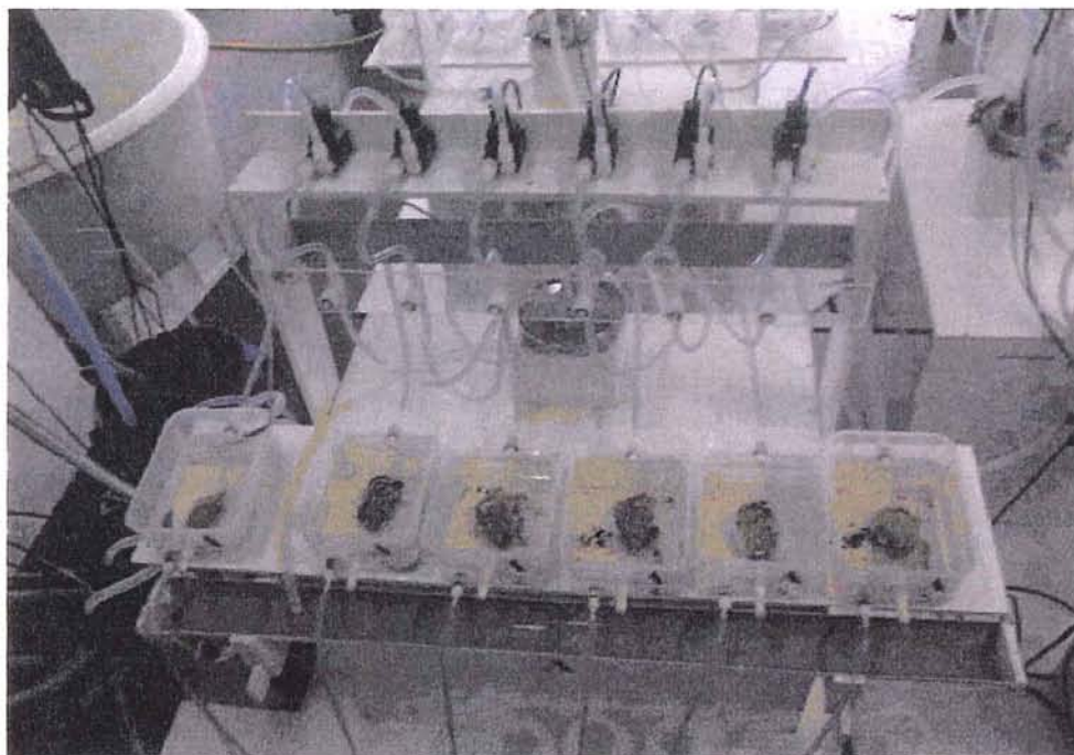
Figure 2 : Stand sur lequel sont disposées les six boîtes individuelles contenant chacune une huître. On distingue derrière le stand la chambre d'homogénéisation.
