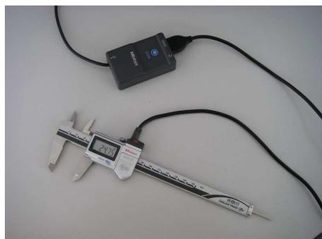
*Figure 2 : Pied à coulisse électronique relié à l'ordinateur par l'intermédiaire de « l'input tool »*
