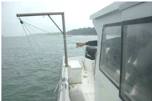
Figure33 : a) Partie immergée de MOGLI (chassis, caméra et sonde), b) Schéma de l'appareillage complet, (c) mise en oeuvre sur le bateau (notez sur la photo le câble électroporteur vert)
