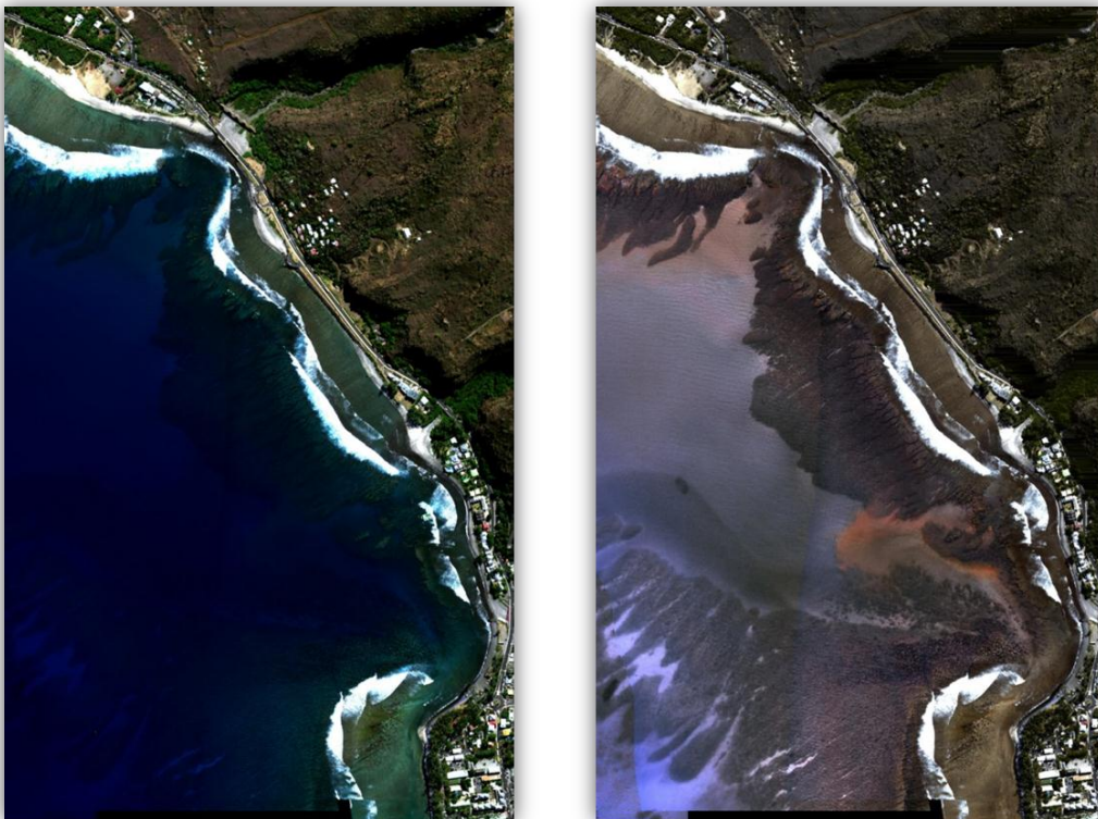
Figure 4 : Baie de Saint-Leu (fausses couleurs). A gauche, image en réflectance au sol avant correction des effets de la colonne d'eau. A droite, image en réflectance au fond après correction. (Les bancs de sable blancs en bas à gauche de l'image se situent entre 20 et 25m de fond).
