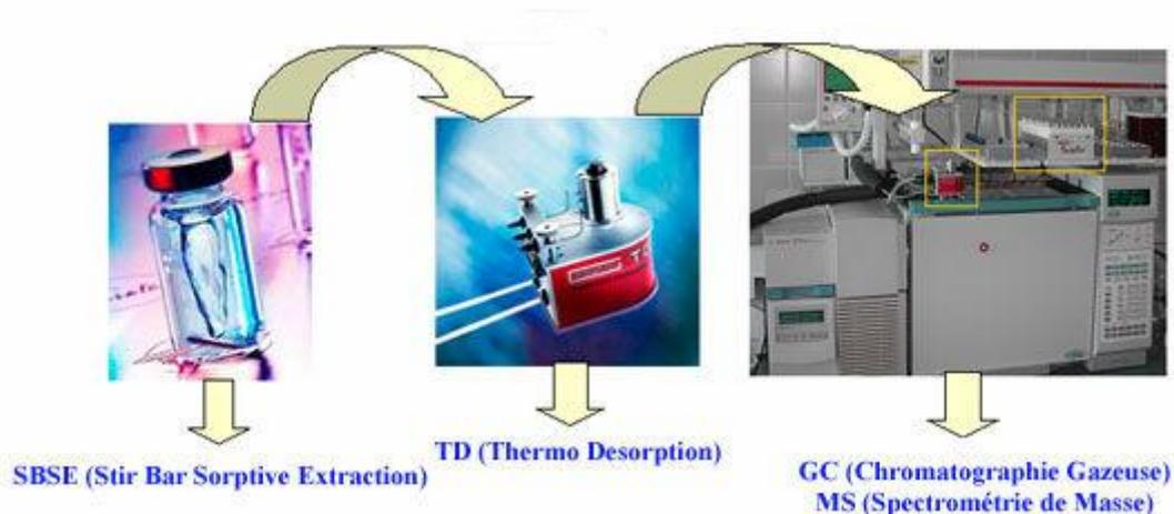
**Figure 8.** Illustration et analyse des SBSE.
