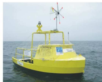
MeDON Observatoire sous-marin câblé à l'île de Molène. Caméra en temps réel, écoute acoustique des mammifères marins, courants, données physico-chimiques
