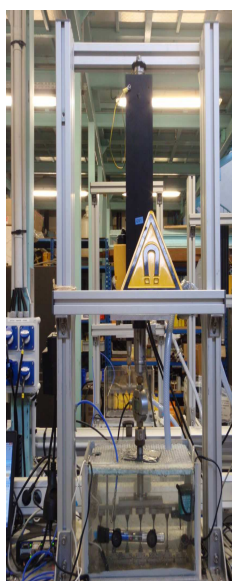
Machine de fatigue en eau de mer permettant de solliciter 7 éprouvettes
