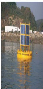
Station de mesure Marel Iroise (Ste Anne du Portzic) Analyse en continu à haute fréquence des paramètres physico-chimiques de l'eau de mer (T, Sal, Turb, Fluo, O 2 , CO 2 )
