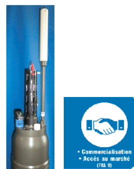
Provor avec mesure d'oxygène et transmission Iridium
