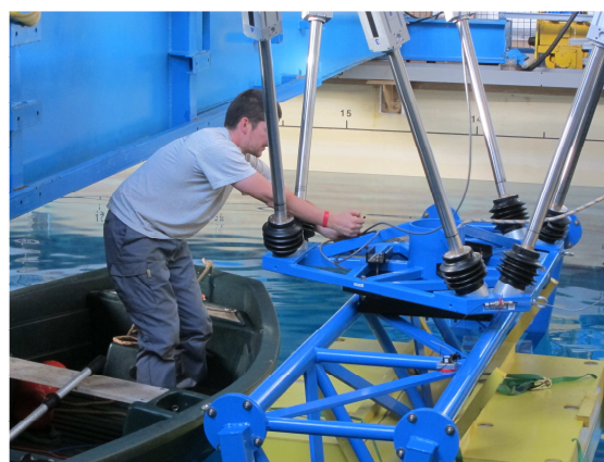
Palonnier fixé sous l'hexapode (en jaune : le flotteur servant à approcher le palonnier en flottaison sous l'hexapode)
