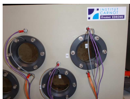
Vue d'ensemble des systèmes de tests de protection des hublots
