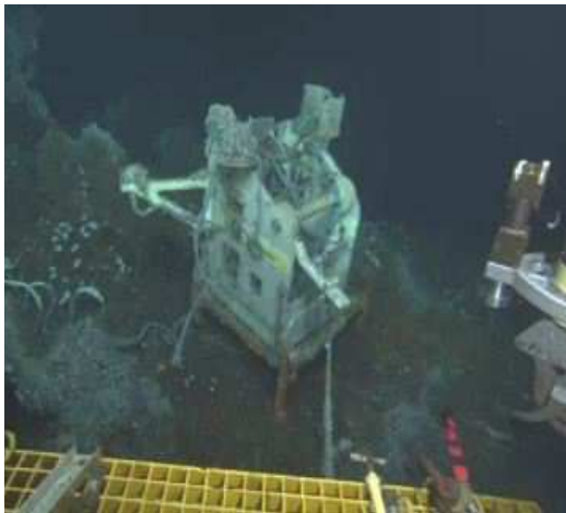
Récupération du module Tempo-Mini par le ROV ROPOS
