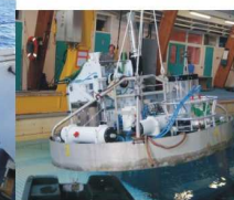
Module d'observation Tempo-mini et sa caméra sur la station fond de mer SEAMON
