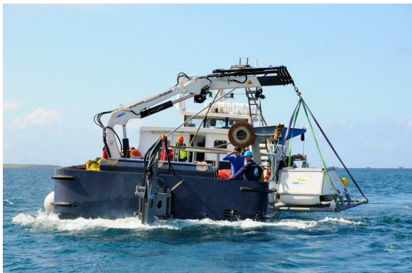
Barge Iroise Mer affrétée par France Télécom Marine pour le déploiement de l'observatoire
