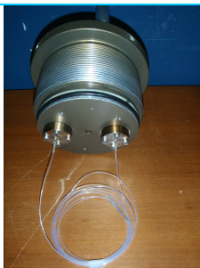
Bouchon de caractérisation sous pression des fibres
