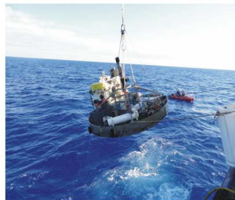
Module d'observation Tempo-mini et sa caméra sur la station fond de mer SEAMON
