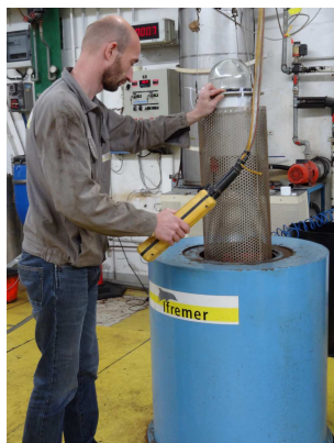
Qualification en pression des différents composants
