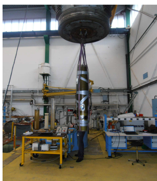
Déploiement de la coque dans le caisson hyperbare
