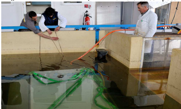
Essai de fonctionnement longue durée en canal de courantométrie
