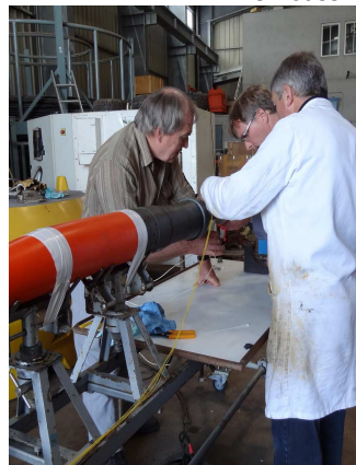
Câblage de la terminaison du câble sous-marin avec FT-Marine
