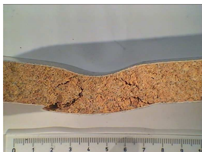
Eprouvettes de bio-sandwich, peaux en résine polyester partiellement bio-sourcée, renforcées de fibres de lin, âme en liège, après essais de caractérisation
