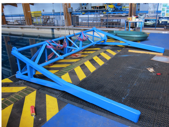
Palonnier en cours de montage
