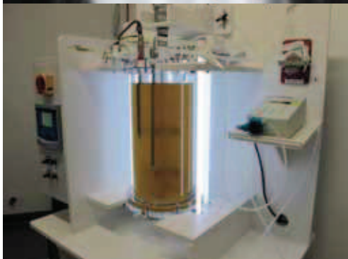
Algothèque en haut et mise en culture de micro-algues en photo-bioréacteur en bas au LEMA (Laboratoire d'Étude des Micro-Algues - ADECAL/Ifremer), locaux de l'ancien Aquarium des Lagons. © Ifremer, L. Loubersac.
