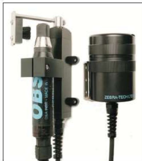
Figure 31 Exemples de dispositifs de mesures de turbidité et de M.E.S. De gauche à droite : transmissiometre (source : NEOTEK) ; OBS (source : ZEBRA TECH Ltd.)
