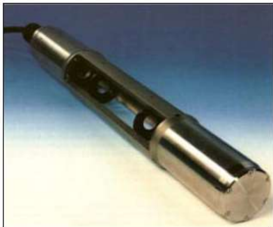
Figure 31 Exemples de dispositifs de mesures de turbidité et de M.E.S. De gauche à droite : transmissiometre (source : NEOTEK) ; OBS (source : ZEBRA TECH Ltd.)
