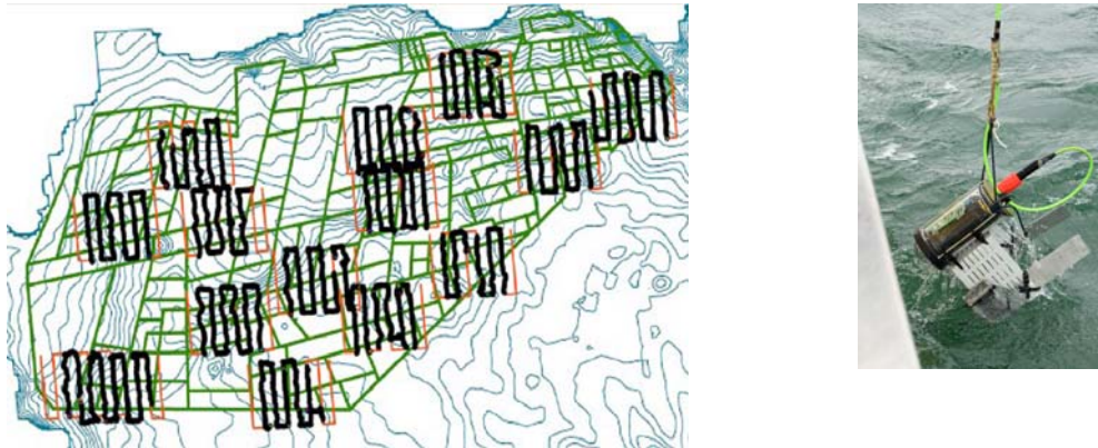
figure 7 : parcours de vidéo sous-marine tractée, autour de 15 stations de la Baie de Quiberon ; photo de droite : caméra video « mobidic » tractée (Gilles Hervé, Ifremer-Toulon)
