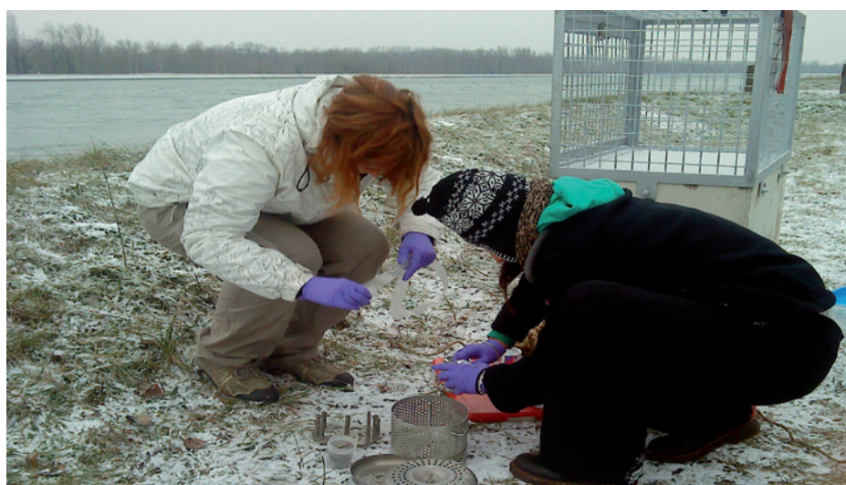
Préparation de l'installation d'échantillonneurs passifs SPMD dans la rivière.
