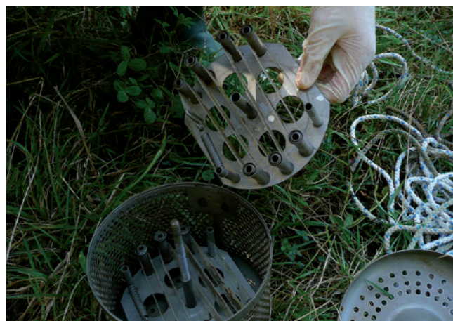
Figure 11 : Photographies de trois DGT (à gauche) et de deux SPMD (à droite) prêtes à être exposées dans le milieu aquatique (photos : Cemagref).
