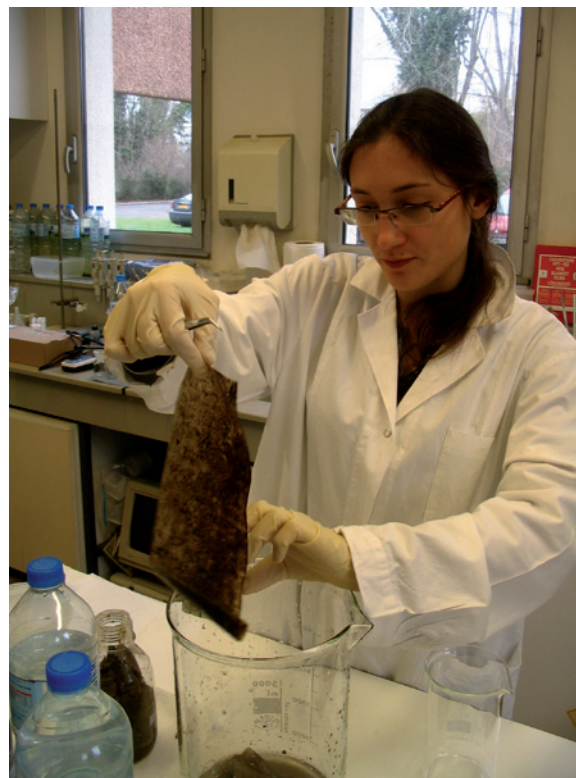
Récupération du biofilm en vue d'un suivi de l'acquisition de tolérance aux métaux des communautés du périphyton.
