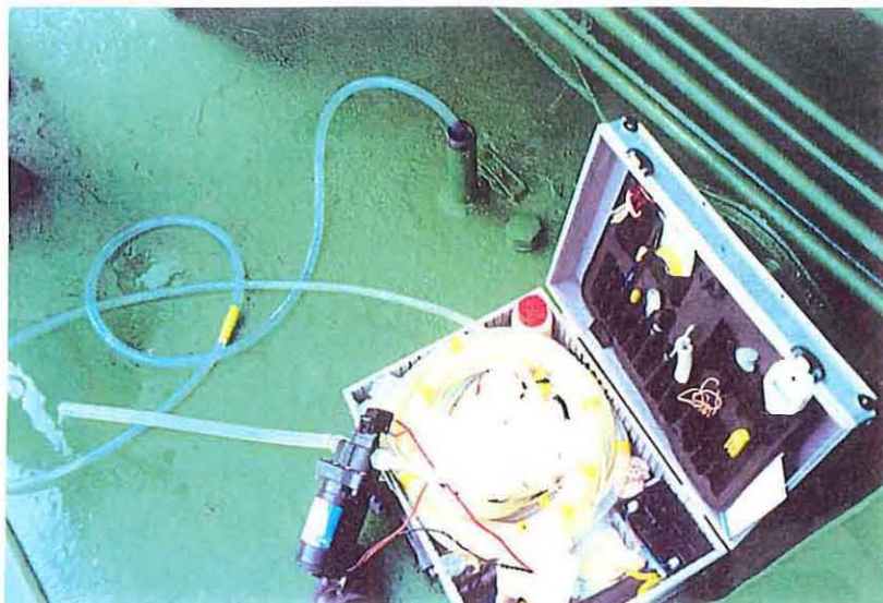
Fig.2: Système autonome de prélèvement(ici avec la pompe aspirante)
