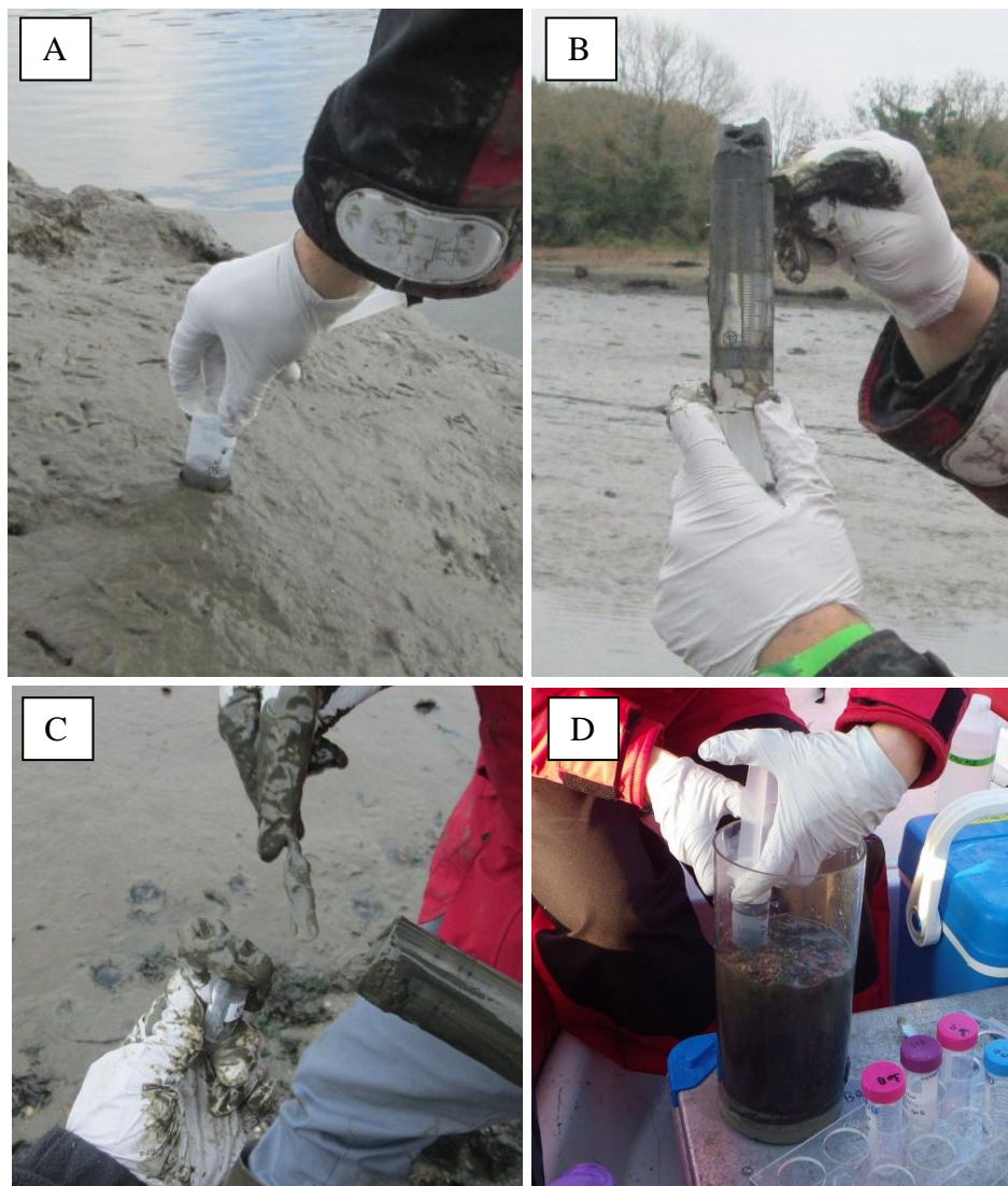
Figure 7 : Recueil de sédiment à pied avec l'aide de seringues :
