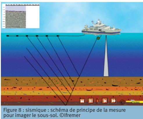
Figure 8 : sismique : schéma de principe de la mesure pour imager le sous-sol. ©Ifremer
