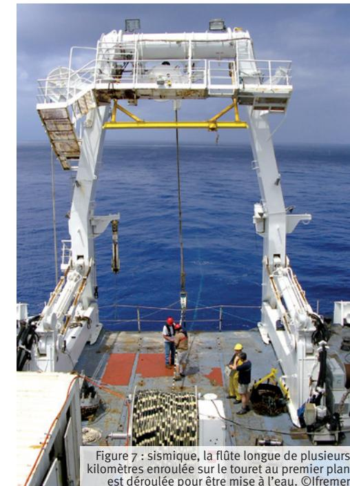
Figure 7 : sismique, la flûte longue de plusieurs kilomètres enroulée sur le touret au premier plan est déroulée pour être mise à l'eau. ©Ifremer
