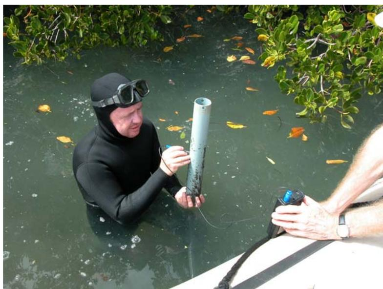
**Figure 4 : Mesure du potentiel rédox dans une carotte de sédiment prélevée en frange maritime de mangrove en octobre 2004.**
