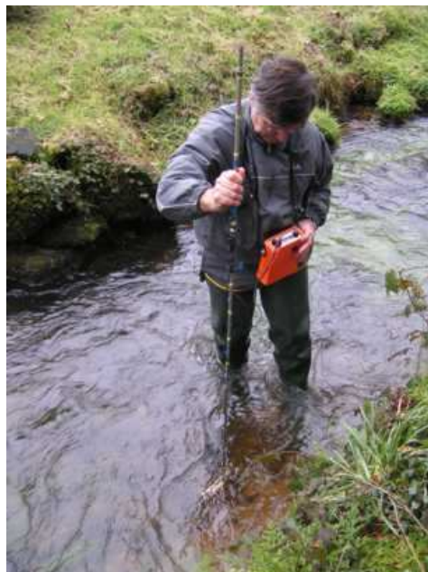
Photo 4 : Mesure de vitesse au moulinet
