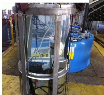
Figure 3 : Capteur NOSS testé en caisson hyperbare à Ifremer Brest.
