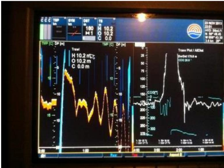
Sur cette photo (ensemble du trait), le capteur ne détectait pas le bourrelet. Quand il le détecte, l'ouverture du chalut est de l'ordre de 9 m.
