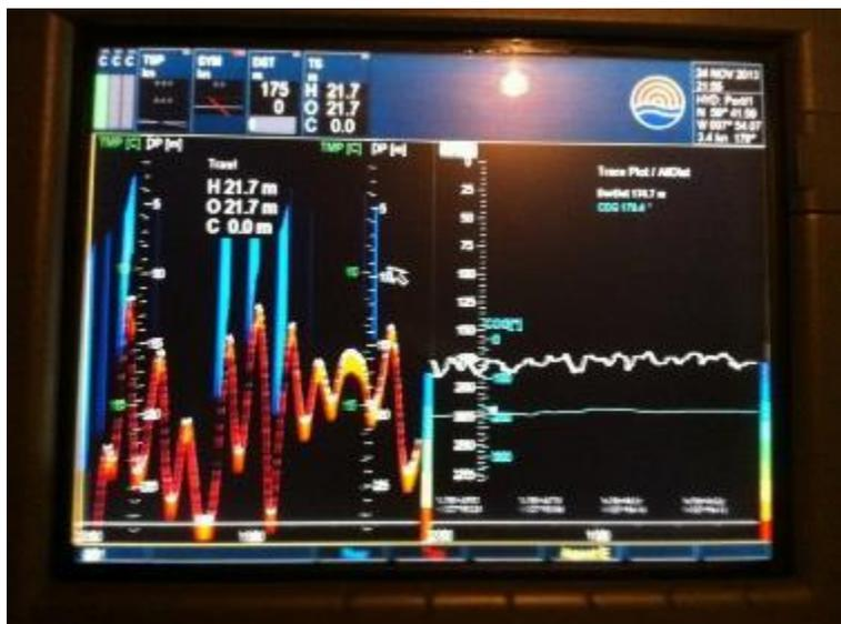
Sur cette photo, le capteur ne détectait pas le bourrelet. Quand il le détecte, l'ouverture du chalut est de l'ordre de 9 m.
