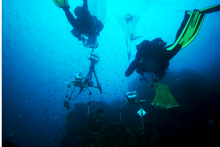
Pose de systèmes vidéo rotatifs STAVIRO. © Ifremer.
