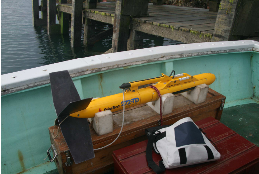
Photo 1 : Sonar latéral Edgetech 272 TD
