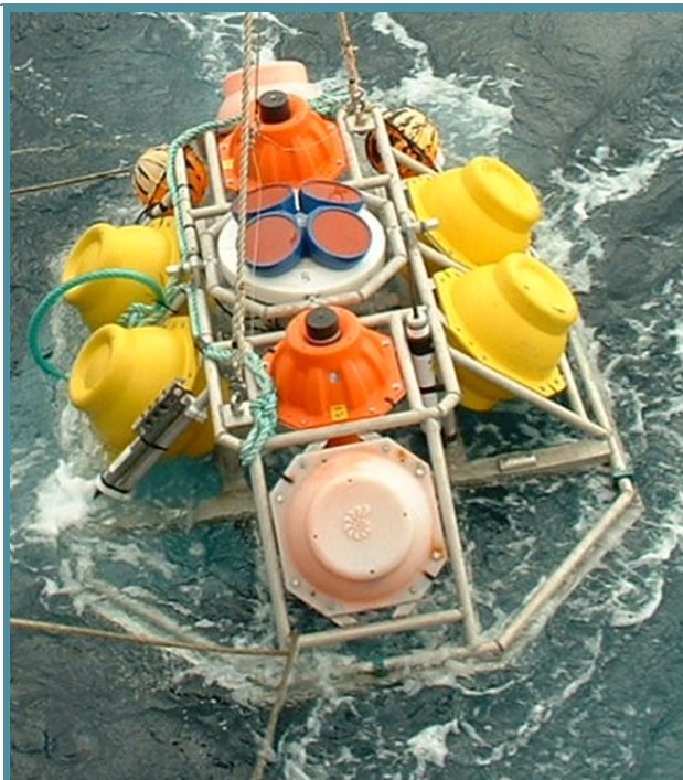
Mouillage en cours de déploiement : le courantmètre, au centre de la structure, est constitué de 4 émetteurs/récepteurs acoustiques qui permettent une mesure toutes les 2 minutes du courant entre le fond et la surface selon des couches de 2 m d'épaisseur.
