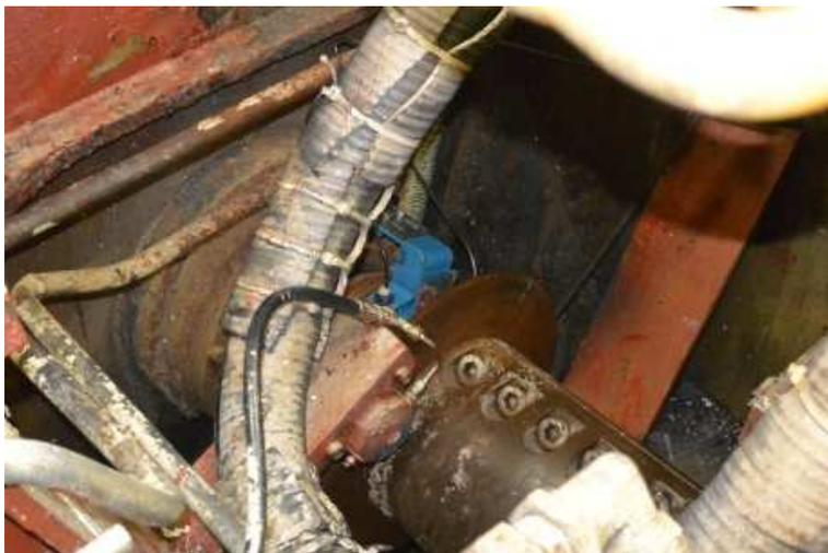
Figure 2 : Torsio-mètre (bleu) sur l'arbre hélice.
