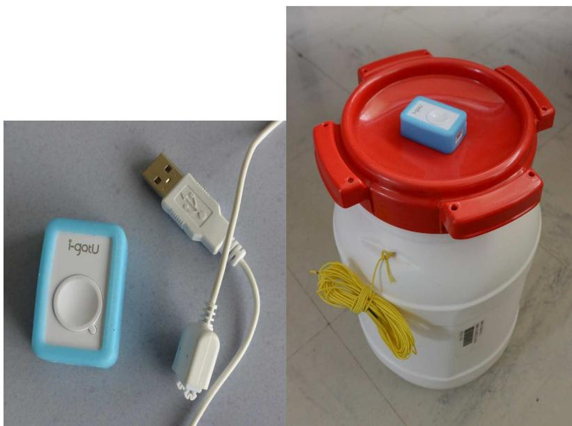
Figure 28 : Les trajectoires de milieux de maillette ont été mesurées par des capteurs GPS (à gauche) et placées dans des flotteurs reliés aux maillettes par des garcettes (à droite).
