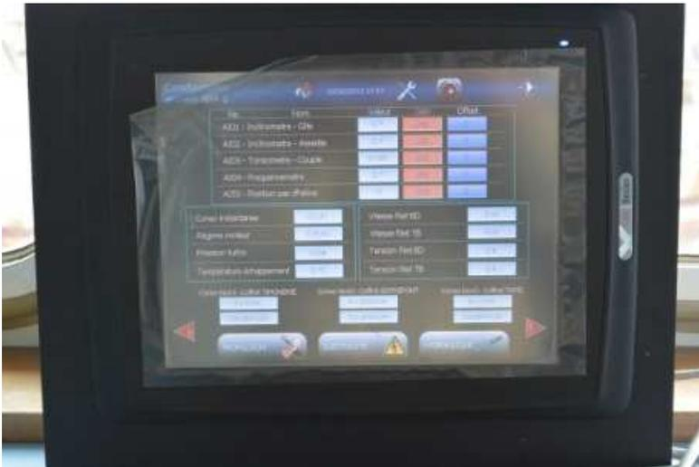
Figure 3 : Ecran de contrôle des enregistrements du débitmètre de carburant, du couplemètre, des vitesses de treuils et capteurs électriques.
