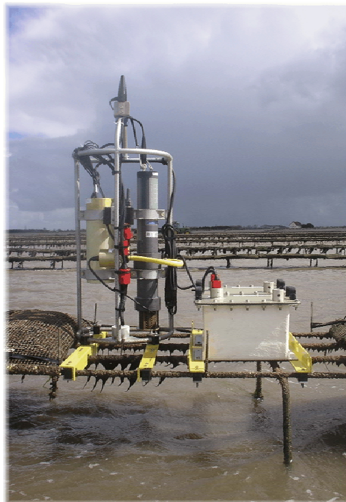
Figure 23 : Système MAREL-ESTRAN déployé en baie des Veys depuis 2005.
