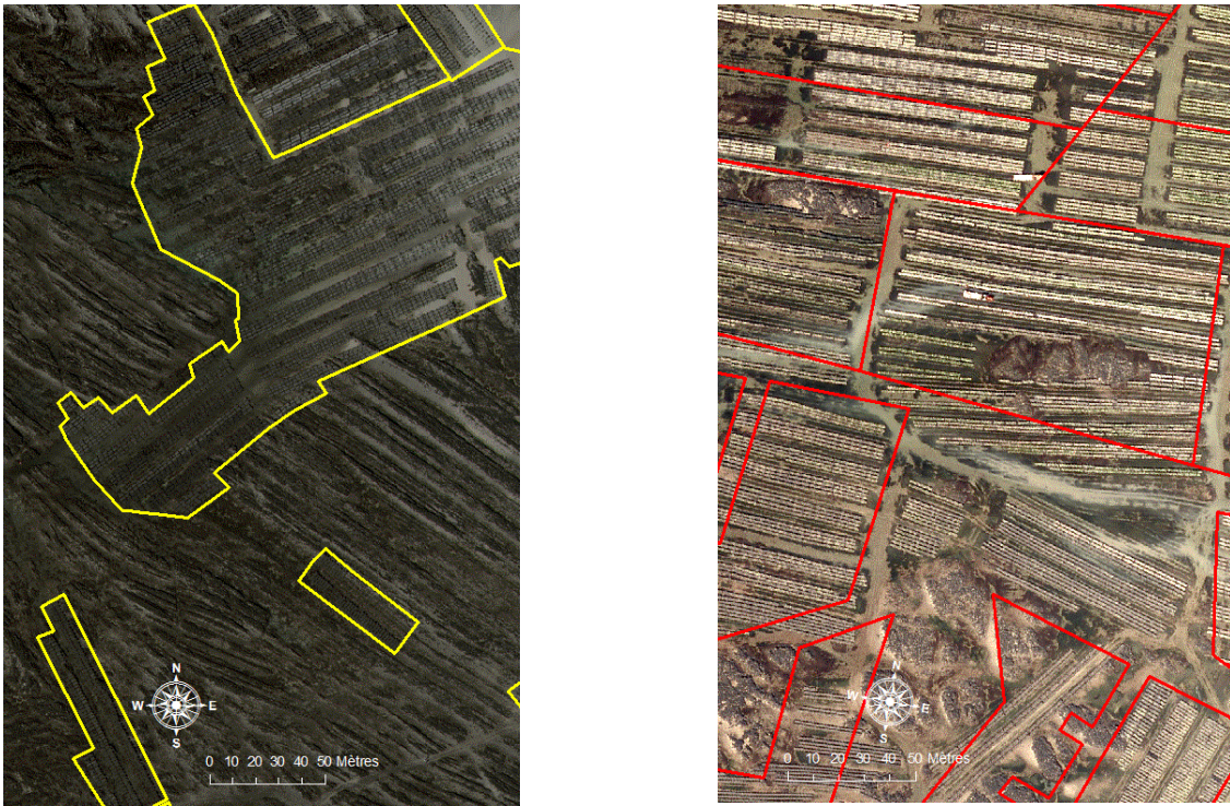
Figure 6 : Illustration des principales contraintes rencontrées dans l'exploitation numérique des prises de vues aériennes. (à gauche : liée à la nature des fonds ; à droite : liée à l'ajustement du cadastre conchylicole).
