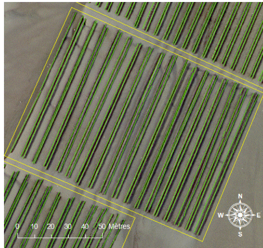
Figure 8 : Illustration de la technique d'analyse manuelle pour évaluer le nombre de poches ostréicoles. La longueur des lignes est ramenée au nombre de poches de 0,5 m de large.
