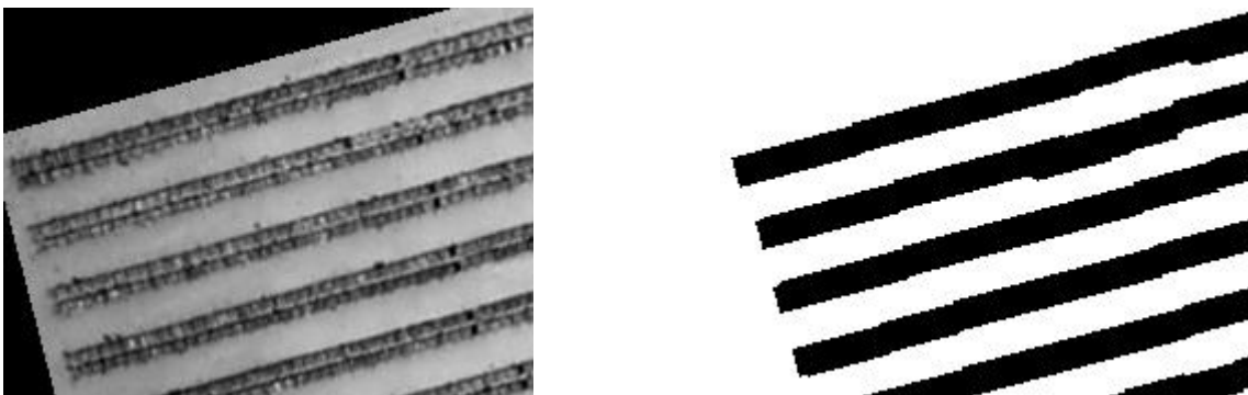
Figure 7 : Illustration du résultat du traitement automatisé d'image pour évaluer le nombre de poches ostréicoles. (à gauche : extrait d'une image initiale ; à droite : extrait d'une image finale, les pixels noirs (20×20 cm) représentent les poches ostréicoles (0,5×1m)).
