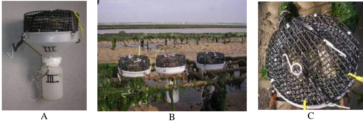
Figure 33 : Collecteurs à biodépôts développés dans le cadre du projet OGIVE (A : ensemble du collecteur ; B : positionnement des collecteurs in situ ; C : vue de dessus d'un collecteur).
