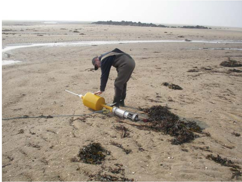
Figure 40 : Bouée SMATCH permettant d'acquérir des mesures de salinité in situ .
