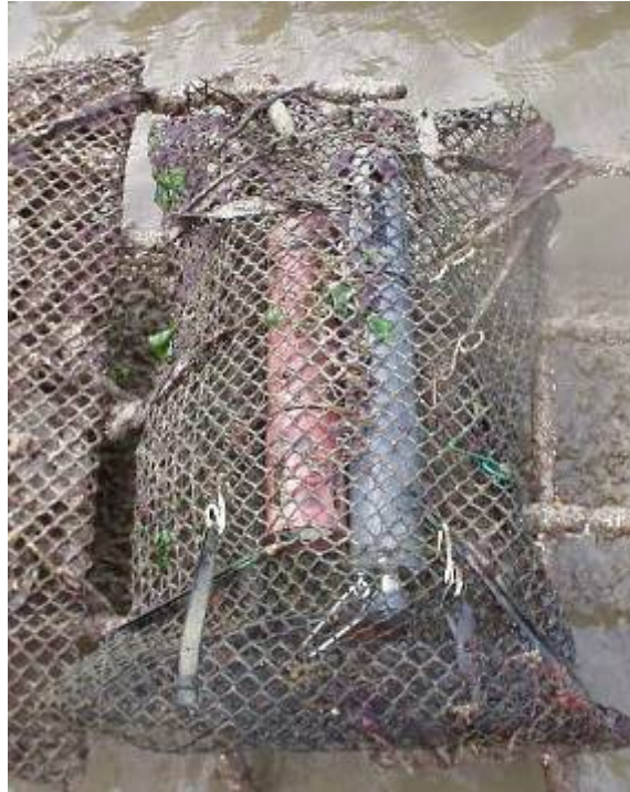
Figure 22 : Sondes multi paramètres haute fréquence en condition in situ dans une poche ostréicole.
