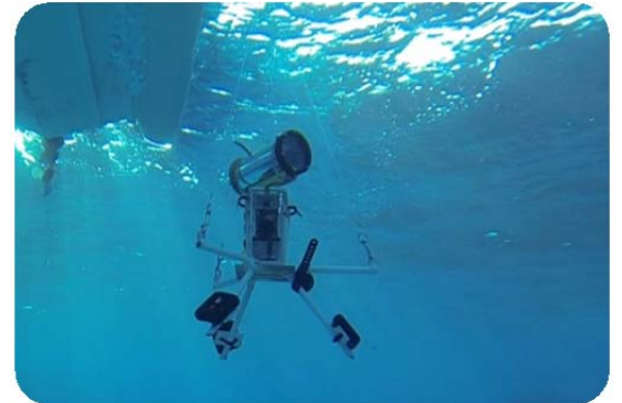
Figure 3. La station vidéo rotative (STAVIRO)
