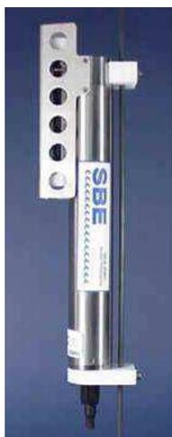
**Figure AII. 3 :** Sonde SBE37 munie d'un capteur de pression, de salinité et température.
