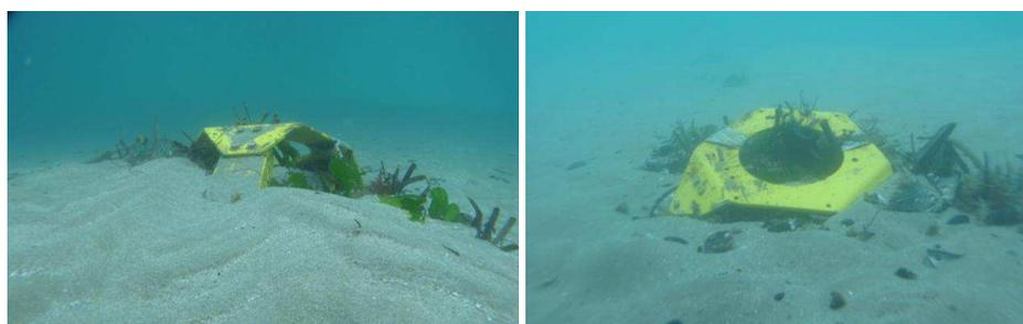
**Figure 8 :** Envasement du tripode qui supporte le courantomètre dans le grau du Prévost (photo IXSurvey - février 2011).
