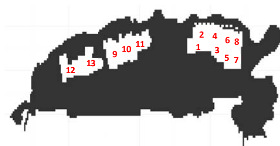
Figure 7 : Localisation, sur la grille de calcul du modèle hydrodynamique MARS-3D, des treize zones d'émission dans les trois zones conchylicoles de la lagune de Thau
