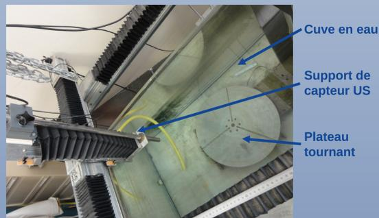
Moyen de test Ifremer des tubes composites aux ultrasons
