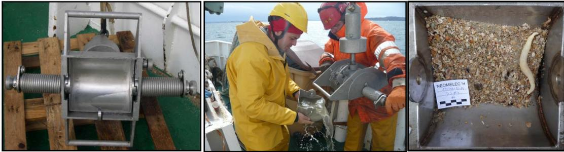
Figure 9 : Benne Shipek et sa mise en œuvre
