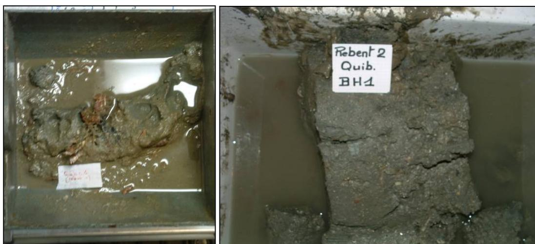
Figure 35 : Prélèvements à la benne Shipek et la benne Hamon dans les sédiments sablo-ensavés, à 100 m de distance
