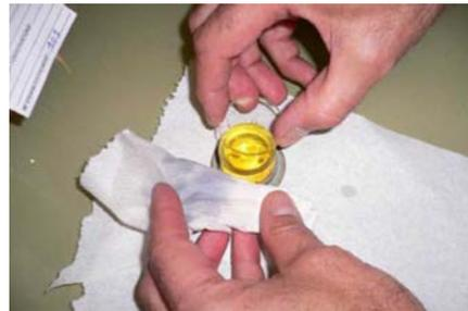
Figure 6 : photo d'une chambre de sédimentation en préparation pour analyse
