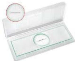
Figure 1 : Image d'une lame micromètre étalon
