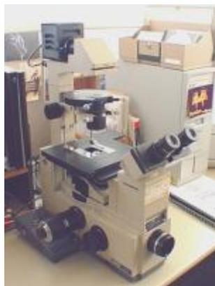
Figure 13 : photo d'un microscope inversé (Olympus IMT2)
