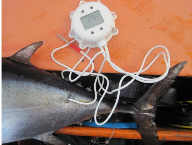
FIGURE 3: POSITIONNEMENT DES SONDÉS POUR LE SUIVI DE LA TEMPÉRATURE DE SURFACE
