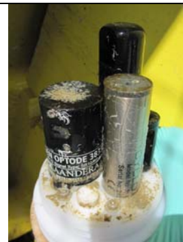
Figure 6 : biofouling sur capteurs sonde MP6
