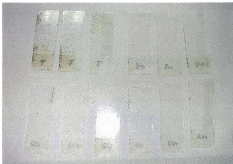
Fig. 17 : Aspect du biofilm couvrant des lames de verre après 18 jours d'immersion en lagon. 800, 657 et 1644 sont les 3 molécules testées ; T est le témoin (en haut à gauche).
