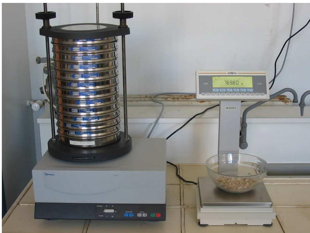
**Figure A2** : Colonne de tamis normalisés et balance à 0,01 g. Photo P.-G. Sauriau ©
