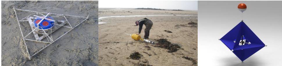
Figure 3 : Courantomètre Doppler point fixe (à gauche), bouée SMATCH (au centre), et bouée iridium (à droite).
