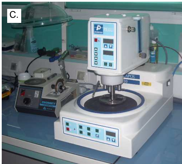
Figure 1 : Technique de préparation des otolithes d'anguilles qui sont inclus dans de la résine (A.) puis coupés transversalement (B.) et enfin polis sur une face (C.).
