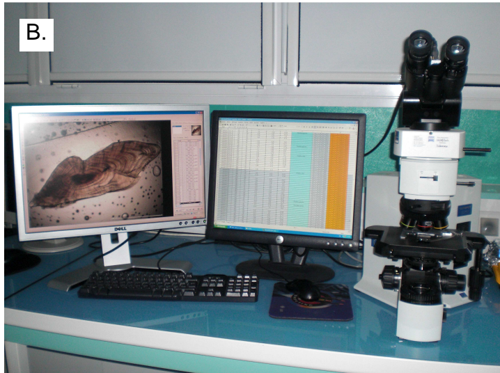
Figure 5 : Traitement numérique des pièces calcifiées (logiciel A. et système d'acquisition et de traitement des images B.).
