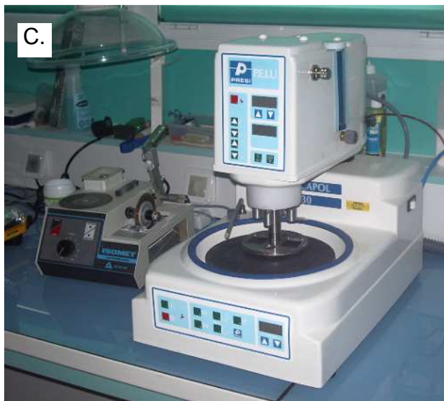
Figure 4 : Technique de préparation des otolithes d'anguilles qui sont inclus dans de la résine (A.) puis coupés transversalement (B.) et enfin polis sur une face (C.).
