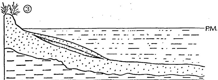
Dépôt de sable recouvrant les hydrocarbures à marée montante.
