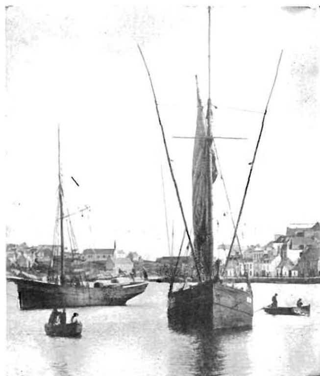
Fig. 98. Thonnier avec ses tangons relevés.
