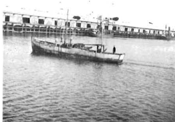
Fig. 29. Chalutier de 46 tonneaux avec moteur 95 C. V. utilisant le chalut à plateaux.
