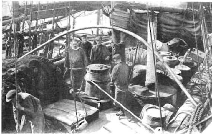
Fig. 41. Le pont d'un harenguier à voiles avec le treuil vertical.
