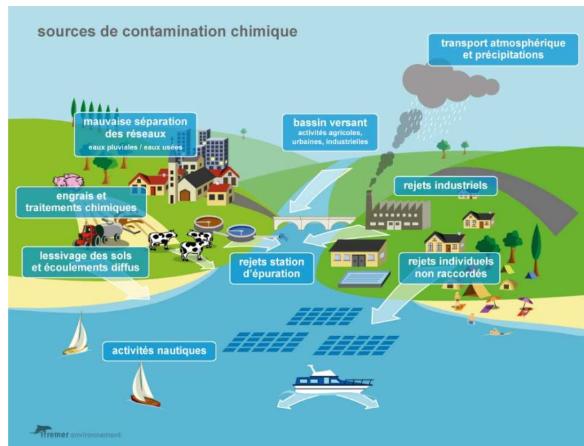
Figure 2 : Les sources de contamination chimique
