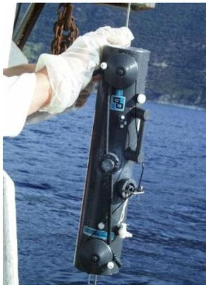
**Figure 1 :** Bouteille à prélèvement Go-Flo (General Oceanics, USA).
