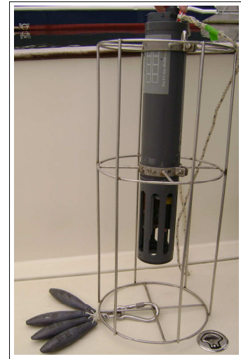
Figure 5a. Sonde multiparamètres Ysi 6600 V2
