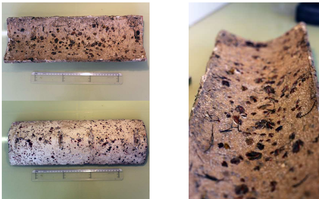
Photo 1 : Tuile chaulée (dessus, dessous et détail) collectée en octobre 2015.
