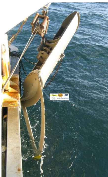
Figure 12 : Panneau Jumper babord monté sur un gréement à fourches.
