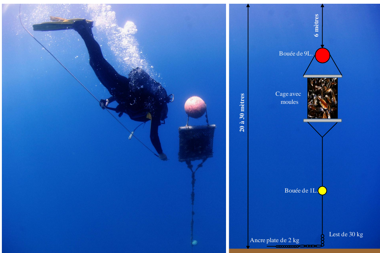
Figure 6 : Photo et illustration de la structure de mouillage RINBIO.
