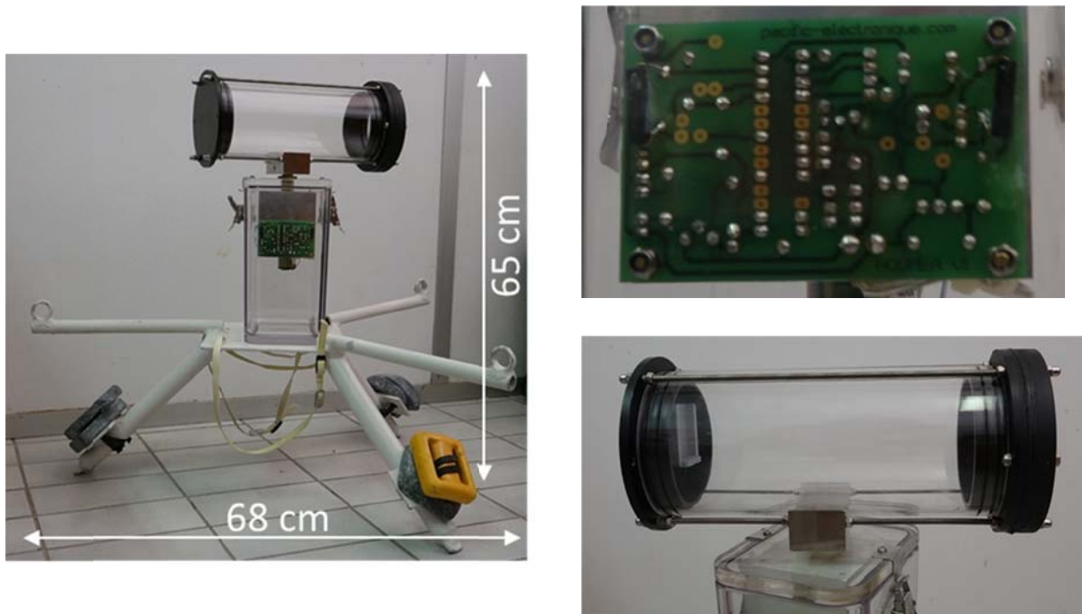
Figure 3. Vue d'ensemble et détails du système STAVIRO utilisé dans le projet AMBIO : carte électronique ARDUINO commandant le moteur et caisson caméra.
