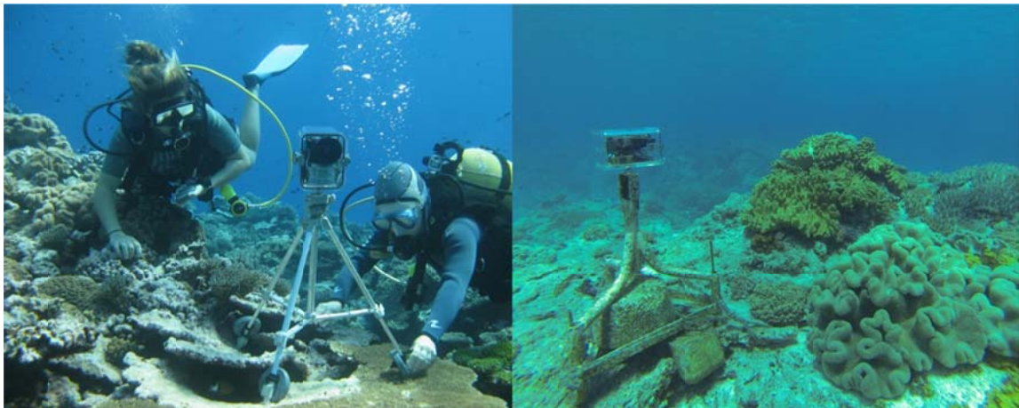
Figure 10. Pose d'un MICADO à Hienghene (gauche) et MICADO en place sur son support fixé au fond dans la passe de Kouaré (droite).
