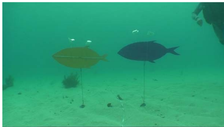
Figure 13 : Exemple de silhouettes de poisson, ici poissons de 1 m situés à une distance de 2 m de la caméra.
