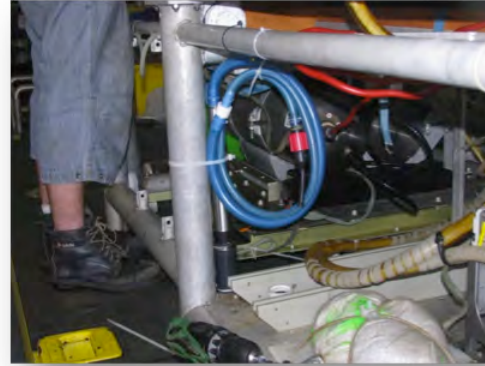
Figure 2.3.2. (left) : Câble équi-pression avec sonde Paros. Figure 2.3.3. (right): Ensembles montés sur le ROV
