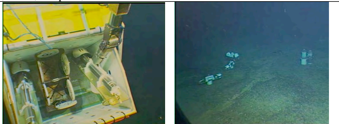
Transport des 2 SB53 + boîte de marqueurs dans un bac de l'ascenseur, dépôt au fond
