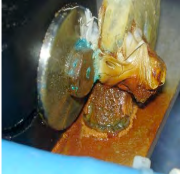
Canule laiton Paroscientific (End cape antifouling)
